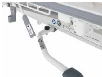
Pedál hydraulického zdvihu zajištěný systémem Segufix.
